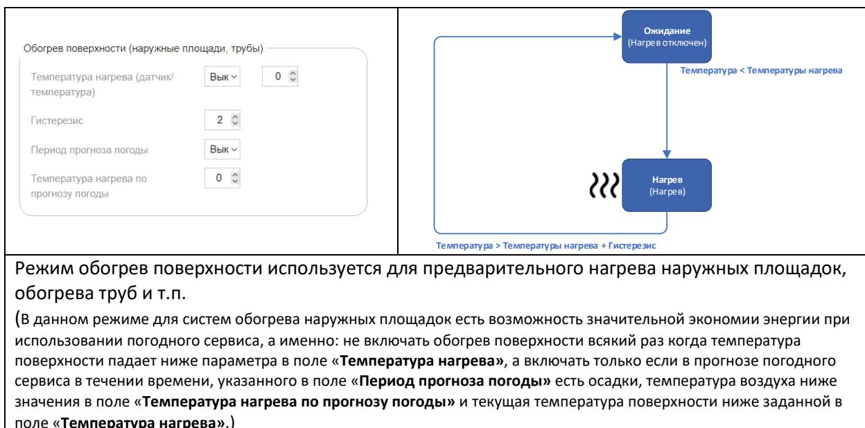
Режим обогрев поверхности используется для предварительного нагрева наружных площадок, обогрева труб и т.п.
