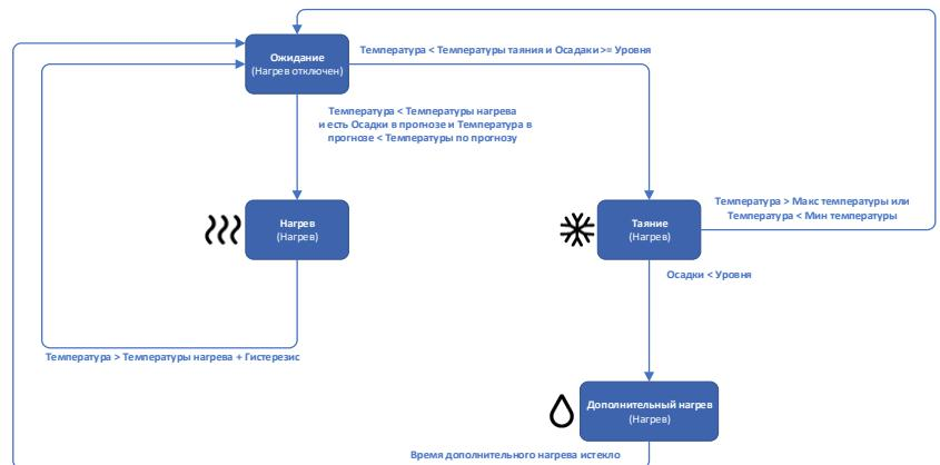
В данном примере система включает обогрев поверхности только, если в 3 часовом прогнозе погоды есть наличие осадков и температура воздуха ниже заданной в поле «**Температура нагрева по прогнозу погоды**». Таким образом, происходит существенная экономия электроэнергии. Обогрев поверхности в данном случае происходит до температуры заданной в поле «**Температура нагрева**» и «**Гистерезис**».
